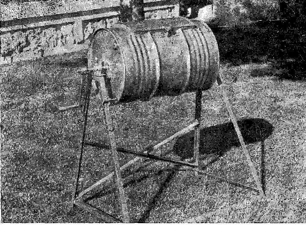
ŞEKİL 6. A tipi tohum ilâçlama aletinin son durumunda kapağı kapalı olarak görünüşü (Foto: Ankara Ziraî Mücadele Enstitüsü, K. Ünal)
