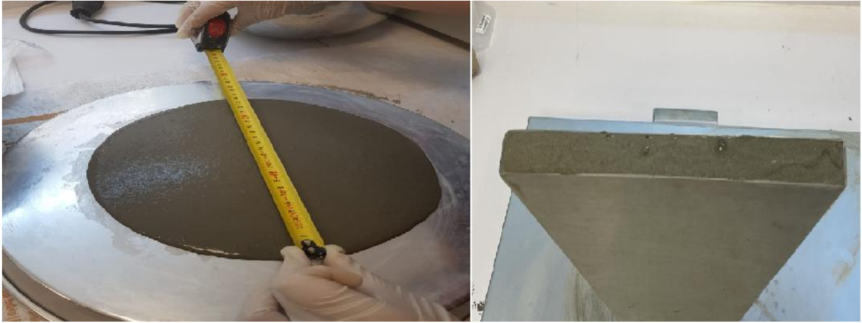
Şekil 2. Mini çökme-yayılma ve V-hunisi testi (Mini collapse-diffusion and V-hunting test)
