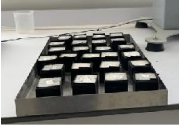
Şekil 7. Kapiler su emme deneyi (Capillary water absorption test)
