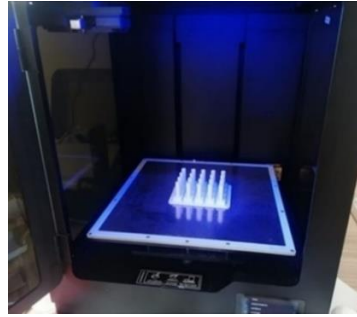
Şekil 4. Auksetik kavelaların 3B yazıcı ile üretimi
