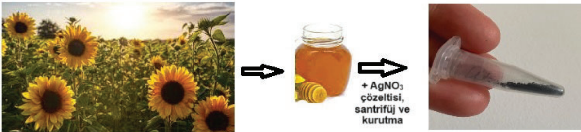
Şekil 1. SH-AgNP'lerin sentezi Figure 1. Synthesis of SH-AgNPs
