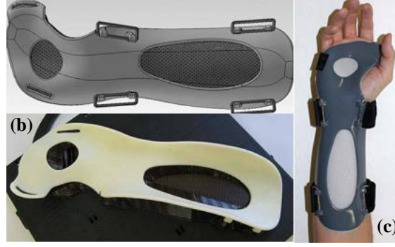
Şekil 14. (a) Ortezın 3B modeli, (b) 3B yazıcı ile imal edilen ortez ve (c) ortezın kullanımı [23]
