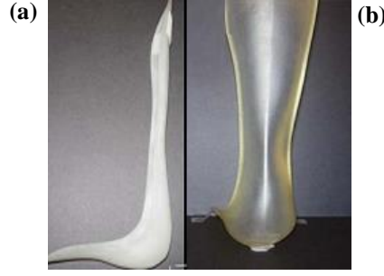
Şekil 9. Farklı malzemelerle üretilen AFO'lar: (a) Accura 40 ve (b) Epoxy [11]
