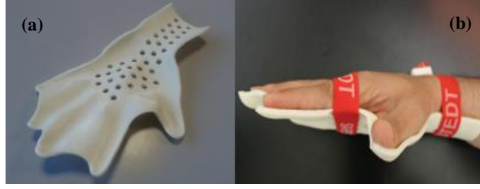
Şekil 11. (a) 3B yazıcı ile imal edilmiş ortez ve (b) Ortezin kullanımı [19]
