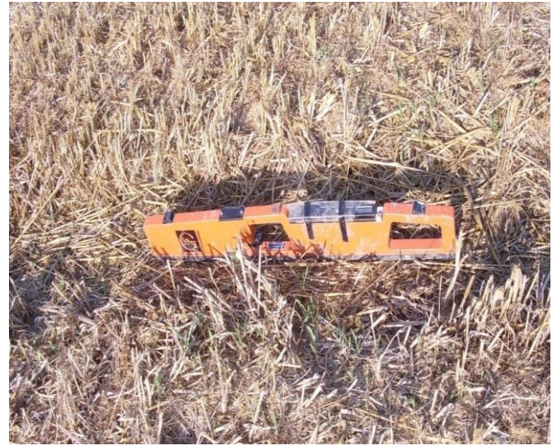
Şekil 2. EM38'in düşey kullanımı.
