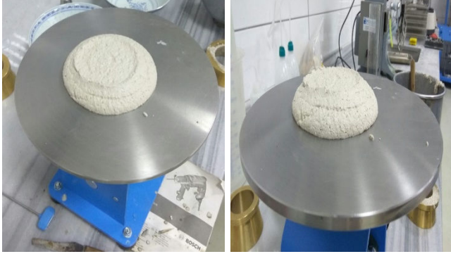
Şekil 10. Harç karışımlarının yayılma deneyi (Slump test of mortar mixtures)
