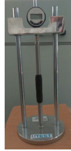
Şekil 2. Harç kuruma-büzülme boy değişimi ölçüm cihazı (Mortar drying-shrinkage length comparator)
