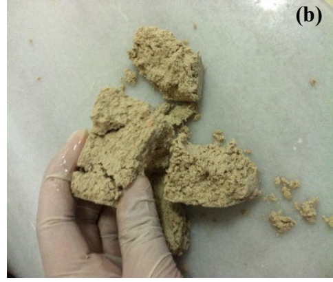
Şekil 5. Harç karışımlarının erken yaşlardaki görüntüleri; a) 1 günlük, b) 3 günlük (Early age images of mortar mixtures; a) 1-day, b) 3-day)
