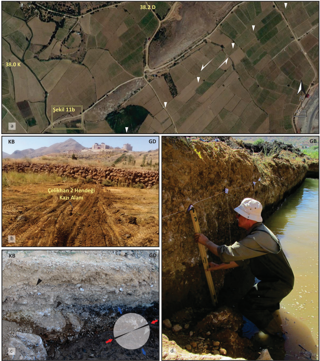
Şekil 11. a) DAFZ Erkenek Segmenti (beyaz üçgenlerle işaretlenmiş) üzerinde açılmış olan Çelikhan-2 hendeğinin konumu, b) hendek kazı alanı arazi görünümü, c) doğrultu gül diyagramı ile fayın hendek içi görünümü (siyah üçgenlerle işaretlenmiş), d) hendek içi çalışmalar.
