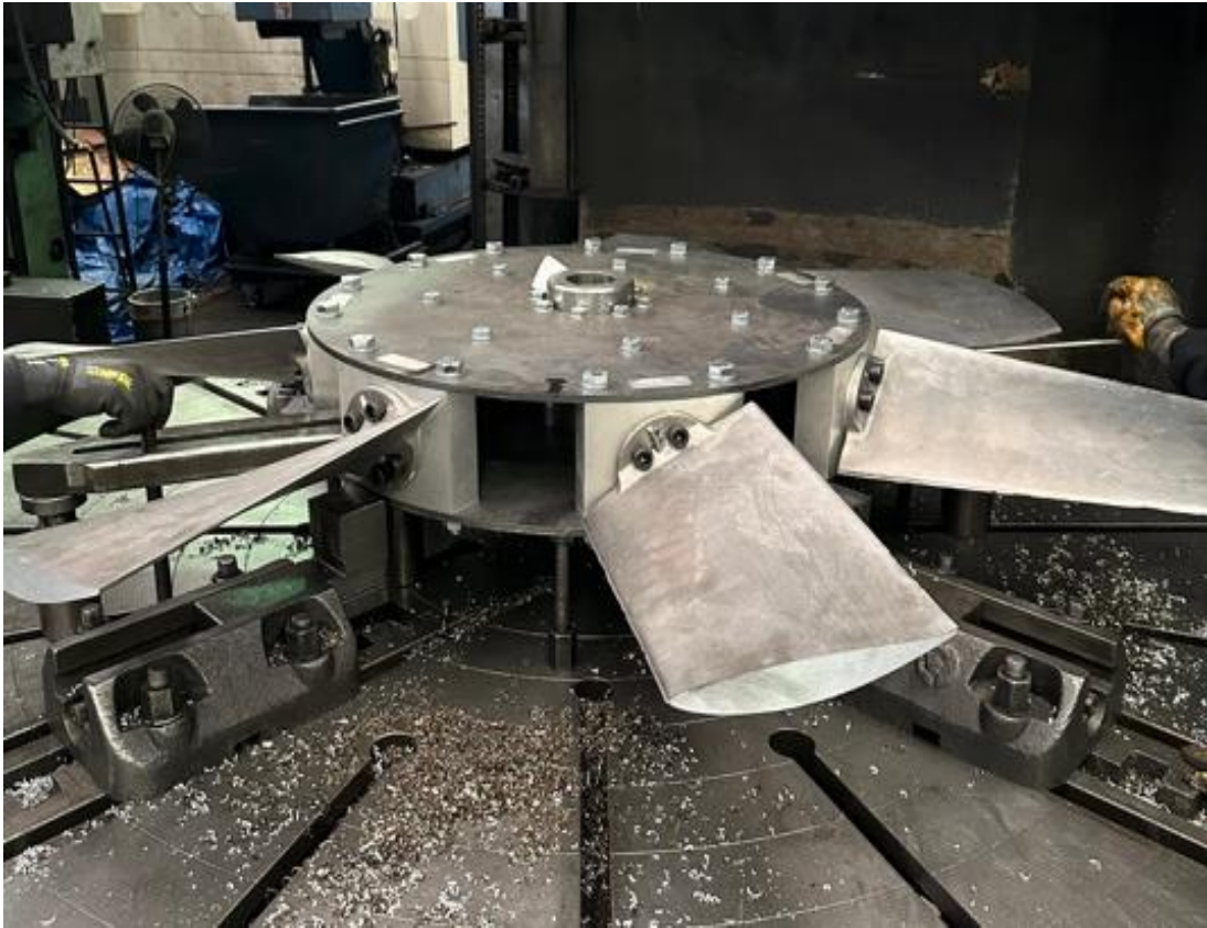
Şekil 6. 1750 Çapında Lost-PLA ile Üretilen Fan Çarkının Dik Torna da İşlenmesi
