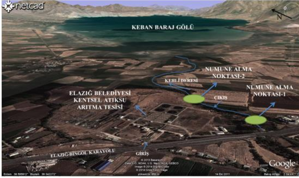
Şekil 1. Atıksu deşarjı öncesi ve sonrası numune alma noktaları
