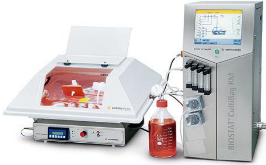
Şekil 15. BIOSTAT®CultiBag RM tek kullanımlık biyoreaktör sistemi ( http://microsite.sartorius.com ) [25]
