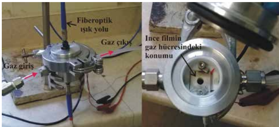
Şekil 2: Optik gaz ölçümlerinin gerçekleştirildiği yalıtılmış gaz hücresi
