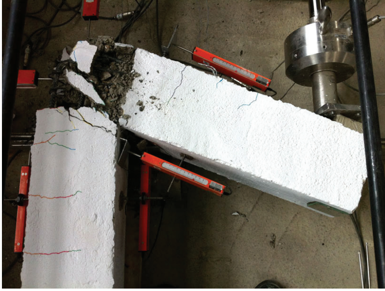
Şekil 9. TS numunesinin göçme sonrasındaki görünüşü
