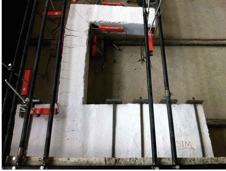
Şekil 10. STM numunesinin göçme anındaki görünüşü
