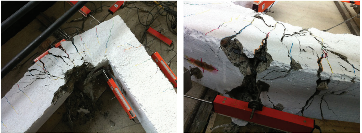
Şekil 11. STM numunesinin göçme sonrasındaki görünüşü
