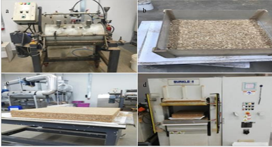
Şekil 2. Deney örneklerinin üretimi (a: Tutkallama, b: Serme, c: Levha taslağı, d: Sıcak pres)
