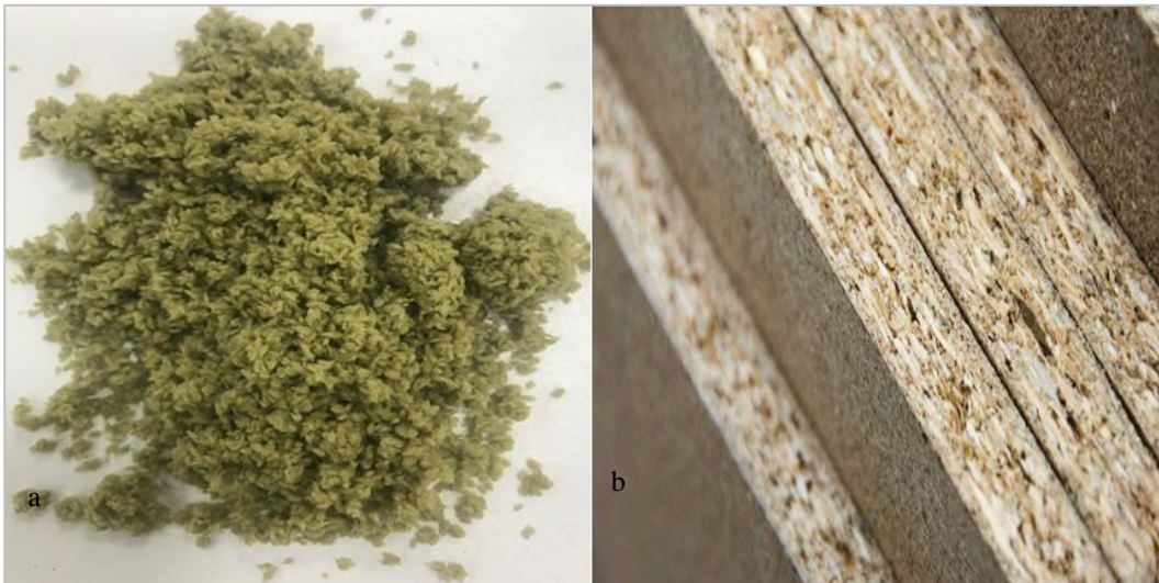
Şekil 1. Taş yünü (a) ve yonga levha profili (b)
