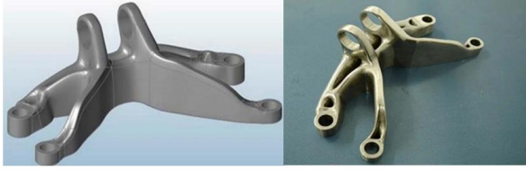
Şekil 17. Optimize edilmiş braketin son tasarımı. (b) Optimize edilmiş DMLS aracılığıyla üretilen ardıl işlem sonrası braket [24] (Final Design of the Optimized Bracket. (b) Post-Processed Bracket Produced via Optimized DMLS)
