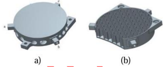
Şekil 15. Metal aynanın CAD modeli (a) ve iç yapısı (b) [23] (CAD Model of the Metal Mirror (a) and its Internal Structure (b))
