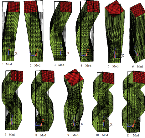
Şekil 7. İçi dolu dikdörtgen kesitli kompozit kolona (R modeli) ait ilk on bir mod şekli
