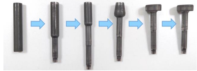
Şekil 11. Beş operasyon adımıyla gerçekleştirilen bağlantı elemanı üretimine ait ham madde, ara ürünler ve ürün görselleri.
