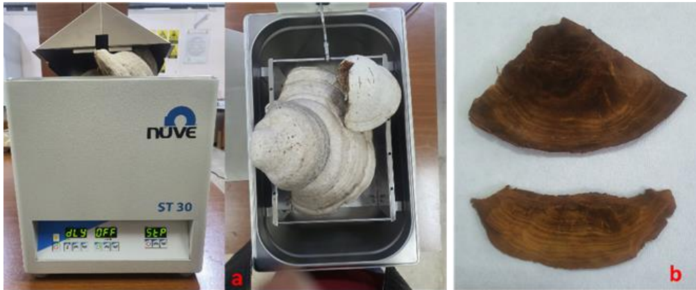
Şekil 15. a) Benmaride Su Buharı ile Mantarların Nem Oranının Artırılması, b) Benmari Deneyi ile Elde Edilen Doku Örnekleri (Yasemin Koparan Kişisel Fotoğraf Arşivi, 2022)
