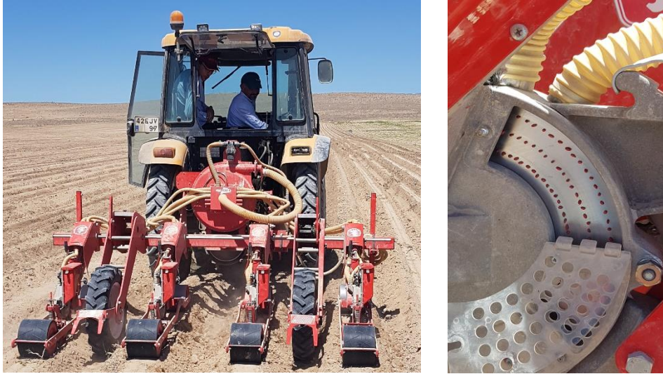
21 Şekil 1. Vakumlu tip pnömatik hassas sebze ekim makinesinin ve ekici diskin görünüşü. 22 Figure 1. The view of the vacuum-type pneumatic precision vegetable sowing machine and 23 the seeding disc.
