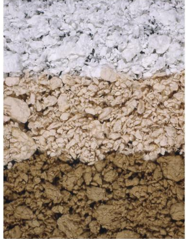
Şekil 1: Primer elyaf üretiminde kademeli ağartma (Brückle, 2009).
