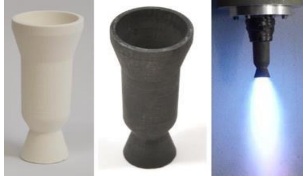
Őekil 9. CMC ile Üretilen Küçük Ölçekli Roket Nozul Çalışması. Soldan Sağa Sırasıyla Preseramik Malzeme, Isıtılmış Seramik ve Test Görüntüleri (Valentine & Gradl, 2019)
