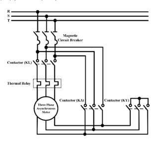
**Figure 3.** Principle diagram of star-delta starting method (Yıldız-üçgen yolverme yönteminin prensip şeması)
