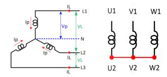
Figure 4. Star connection configuration and motor terminal (Yıldız bağlantı konfigürasyonu ve motor terminali)
