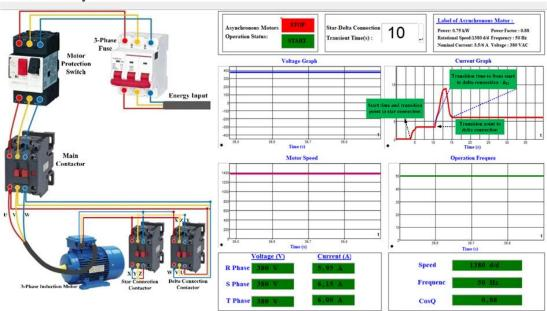
**Figure 9.** Screenshot when the star-delta transition time is 10s (Yıldız-delta geçiş süresi 10s olduğunda ekran görüntüsü)
