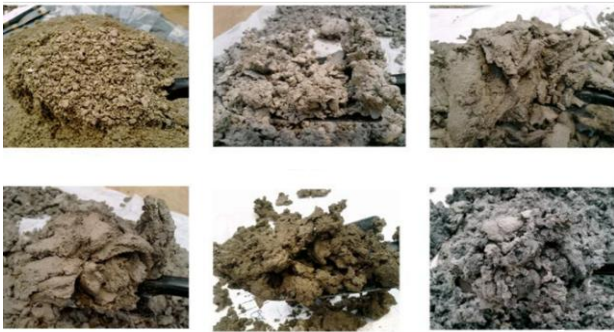
Şekil 10: Farklı kâğıt fabrikalarına ait elek altına kaçan elyaflar (Abdullah vd., 2015).
