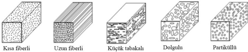
Şekil 1. Takviye Çeşidine Göre Kompozit Malzemeler (Yontar, 2021)
