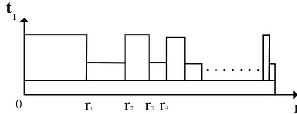
**Figure 4.** 2-Level Phase Fresnel zone plate material structure. The structure has been showed on a substrate material. (2-Seviyeli Faz Fresnel bölge plaka malzeme yapısı. Yapı bir alttaş malzemesinde gösterilmiştir.)
