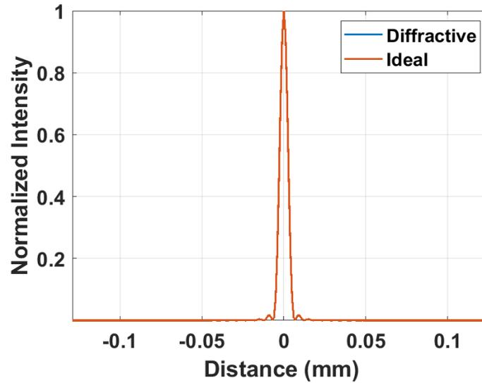
c) Comparison of the 1D intensity distributions of the diffractive lens and its equivalent ideal lens. (Kırınımlı mercek ve eşdeğer ideal merceğin 1D yoğunluk dağılımlarının karşılaştırılması.)
