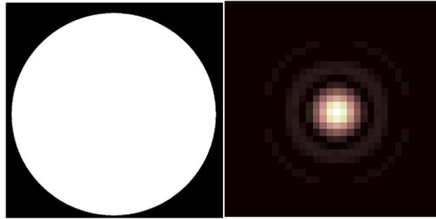
b) Aperture function of the equivalent ideal lens and its on axis focus. (Eşdeğer ideal merceğin açıklık fonksiyonu ve eksen üzerindeki odak noktası)
