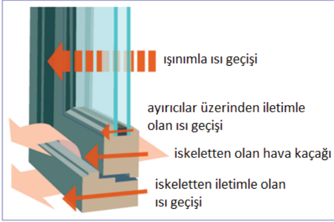
Şekil 1. Konvansiyonel pencerelerde ısı kaybına sebebiyet veren mekanizmalar.
