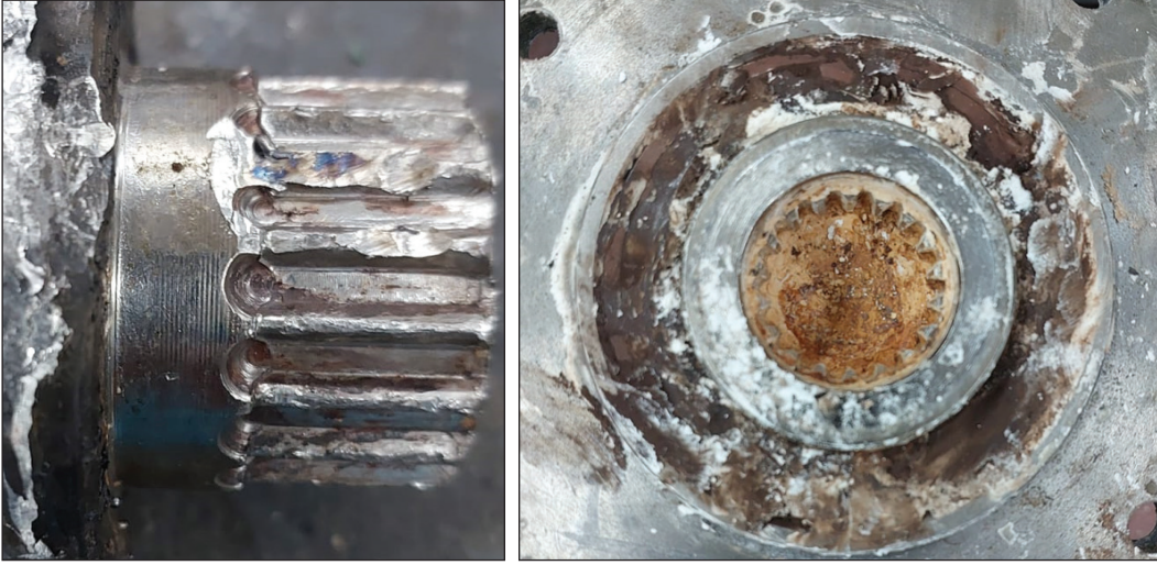
Şekil 20. Uzun duruşa (Class 3) sebep olan dişli arızası.
