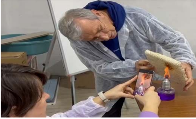
Şekil 10. Yanmazlık deneyi (Bayramoglu, 2023)
