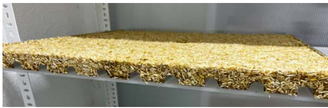
Şekil 6. Biyokompozit Malzemenin Büyütülmesi (Bayramoglu 2024)
