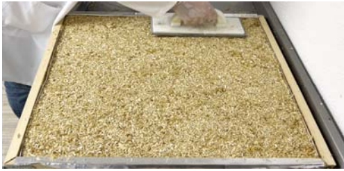
Şekil 5. Hamurun kalıplara dökülmesi (Bayramoglu 2024)
