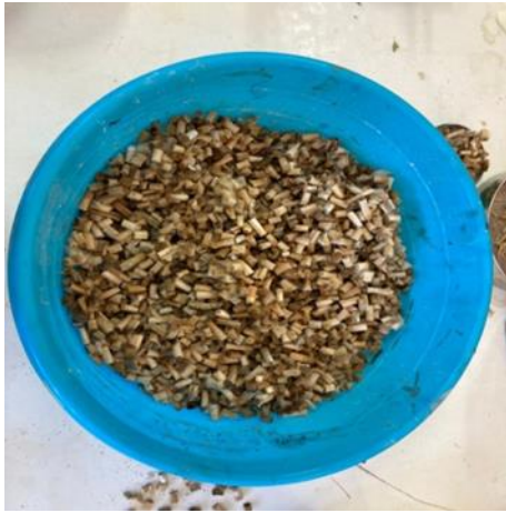
c) Atık sigara izmaritlerinin kaplamalarının soyulması
