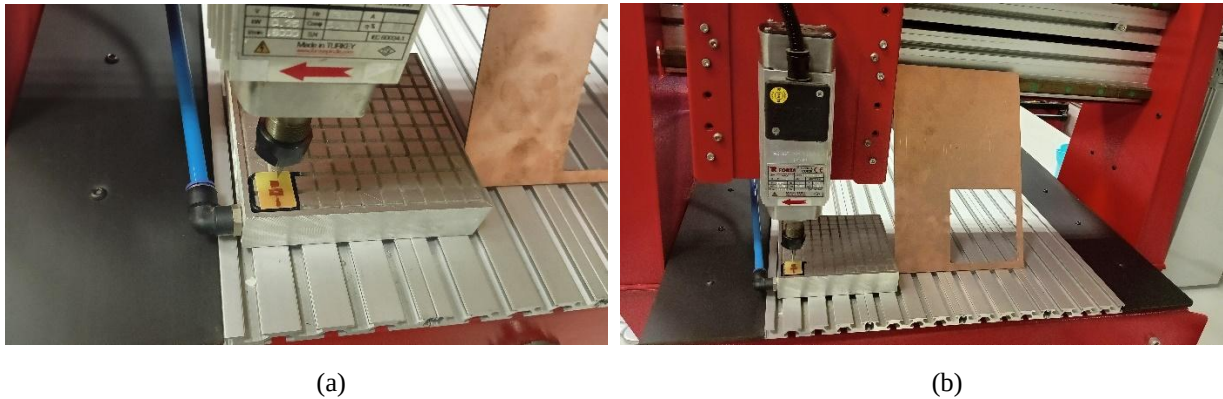
Şekil 3. Üretim için kullanılan (a) çelik blok ve (b) CNC cihazı
