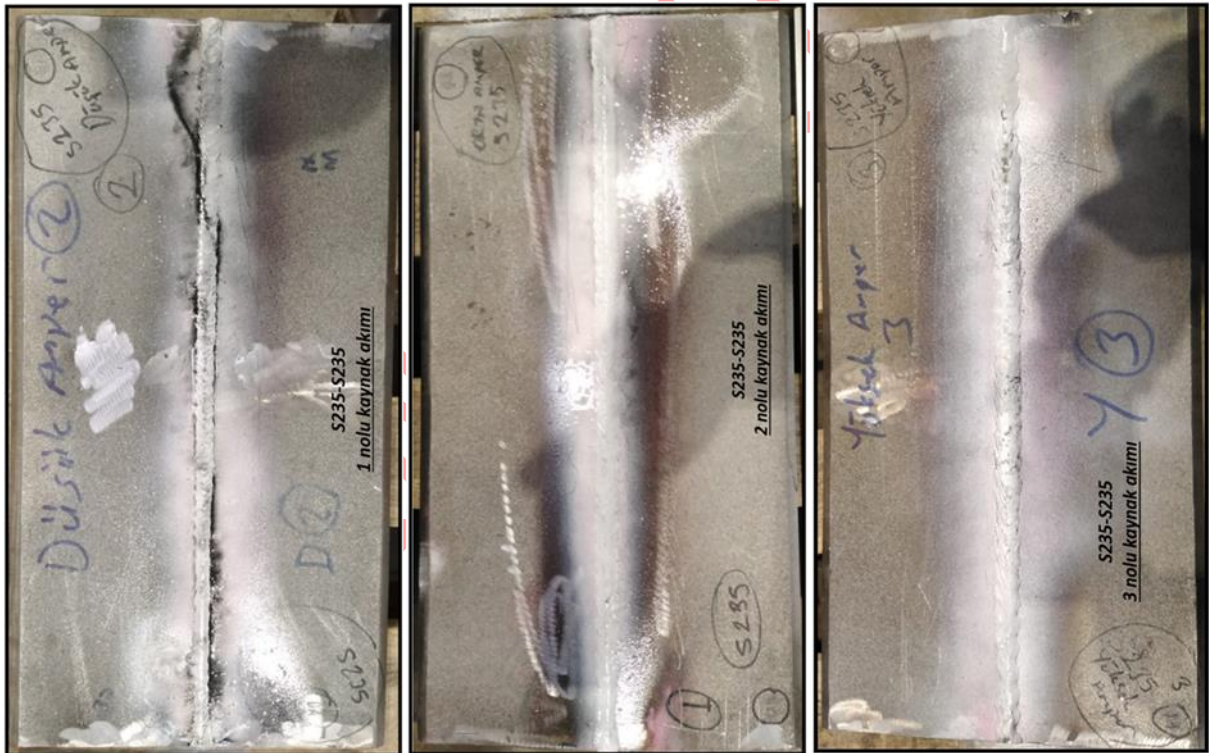
Şekil 7. S235-S235 1, 2 ve 3 numaralı parametreler kullanılan numunenin MT görüntüsü (S235-S235 MT image of the sample using parameters number 1, 2 and 3)
