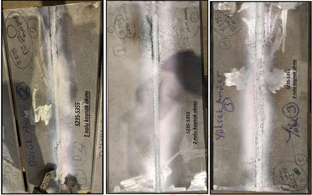
Şekil 8. S235-S355 1, 2 ve 3 numaralı parametreler kullanılan numunenin MT görüntüsü (S235-S355 MT image of the sample using parameters number 1, 2 and 3)
