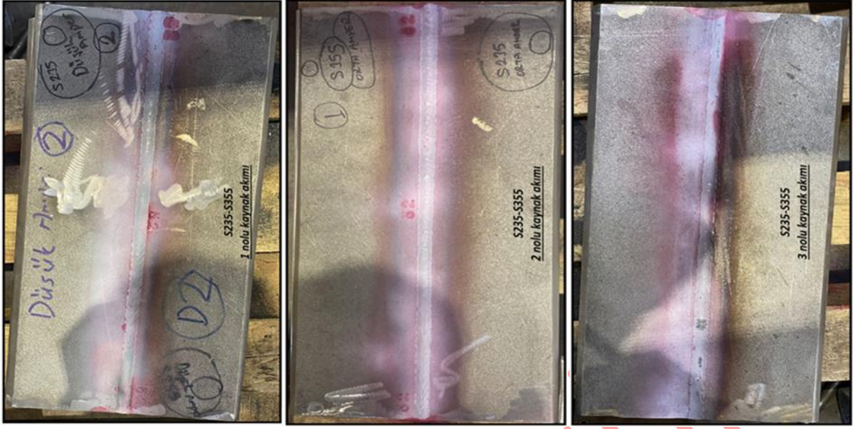
Şekil 4. S235-S355 1, 2 ve 3 numaralı parametreler kullanılan numunenin PT görüntüsü (S235-S355 PT image of the sample using parameters number 1, 2 and 3).
