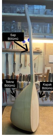
Şekil 1: Bağlamada tekne, kapak ve sap bölümleri
