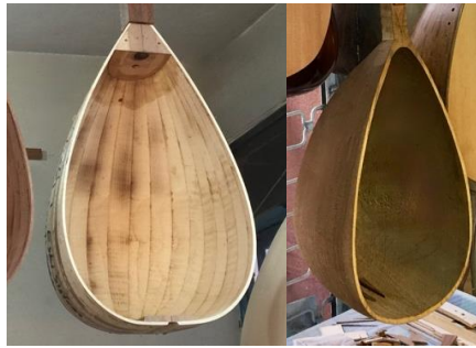
Şekil 2: Bağlamada yaprak (solda) ve oyma (sağda) tekne örnekleri
