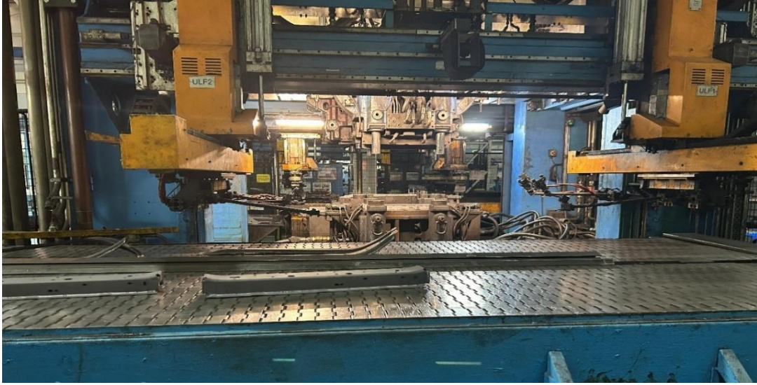
Şekil 3: Sıcak Şekillendirme Prosesinde Soğutma Evresi
