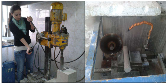
Şekil 2. a) Bloktan karot alımı, b) Karotun uç kısmının düzeltilmesi
