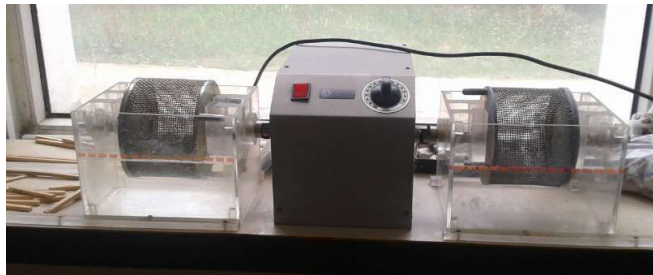
Şekil 7. Suda dağılmaya karşı duraylılık deney düzeneği
