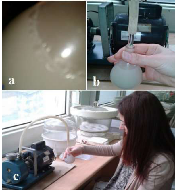
Şekil 3. a) Piknometre içinde oluşan hava kabarcıkları, b) Piknometre vakumlanırken çalkalama işlemi c) Piknometre ile özgül ağırlık deneyi
