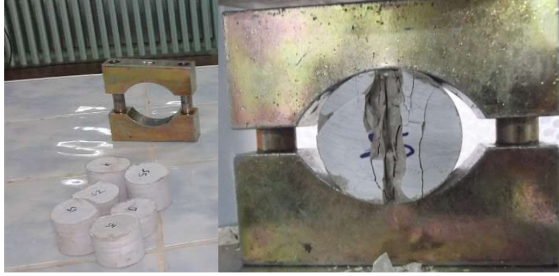
Şekil 4. a) Dolaylı çekme dayanımı (Brazilian) dencisinde kullanılan numuneler ve standart çene, b) Deney sonrasında numunenin görünümü
