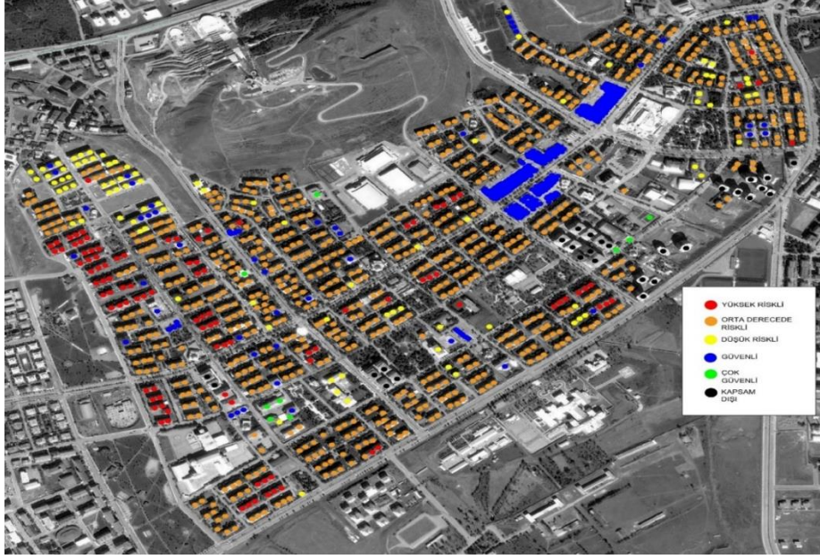
Şekil 8. Yenişehir bölgesi betonarme bina risk dağılım durumunu gösteren hava fotoğrafı
