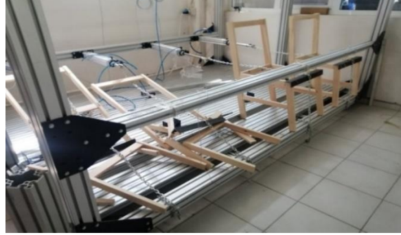
Şekil 7. Önden arkaya yüklenmiş deney sandalyelerinin tipik deformasyonu
