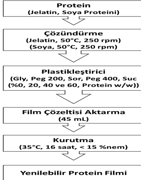
Şekil 1. Yenilebilir film çözeltisi ve film üretimi akış şeması
