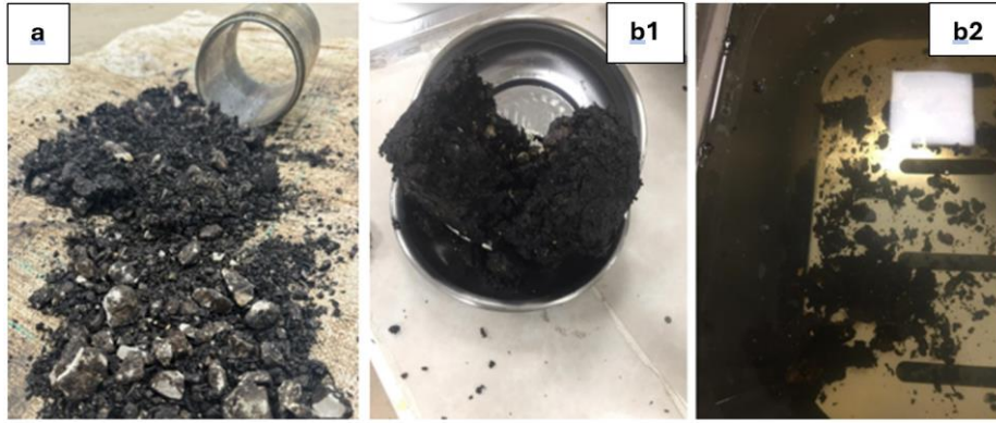
Şekil 3. a) Kalıptan çıkamadan dağılan numune örneği (%30 talaş ikamesi) b) Su banyosunda dağılan numune örneği (%20 talaş ikamesi)
