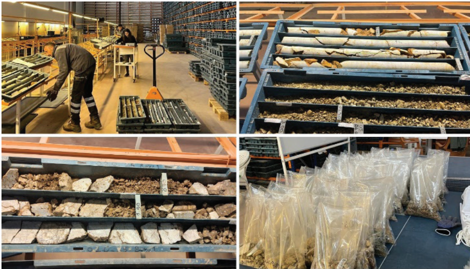
Şekil 4. Sondaj loglarından çıkarılan karotlardan yürütülen yan kayaç örnekleme sürecine ait görseller.
