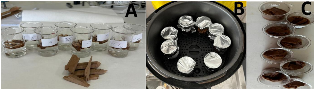
Şekil 1. MDF Geri Dönüşüm aşamaları (A: işlem öncesi, B: hidrotermal işlem C: işlem Sonrası)
