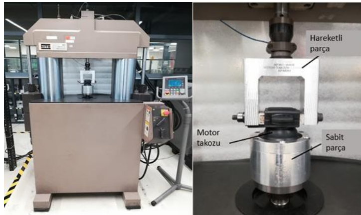
Şekil 6: MTS 831.50 servohidrolik elastomer test cihazı (Kocabiçak ve Açar, 2024)
