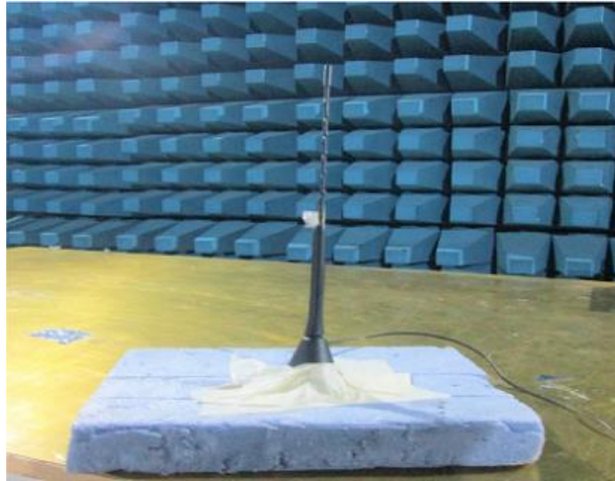
Şekil 25. Yansısız oda içerisinde anten ölçümleri alınırken (Active antenna in anechoic chamber)
