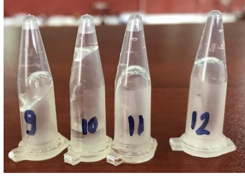
Şekil 8. F9, F10, F11 ve F12 Formülasyonların ters tüp yöntemi ile sol-jel durumları
