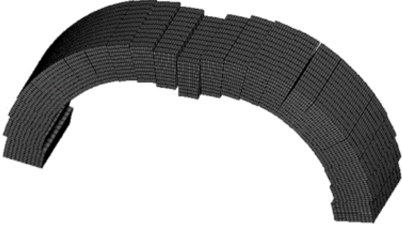
Şekil 11. Kemerde görülen üç boyutlu deformasyon (d=0.01 mm)
