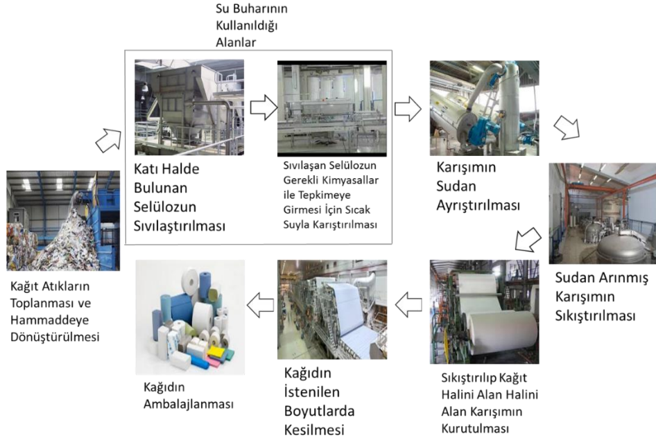
Şekil 2. Kağıt Üretiminde Su Buharının Kullanıldığı Üretim Aşamaları
