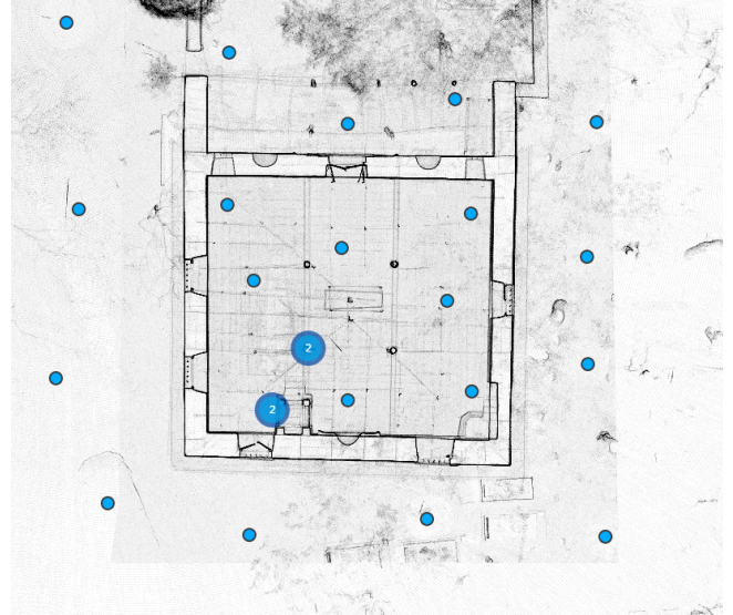
Şekil 2. YLT cihazı tekli yapı için oturum noktaları.
