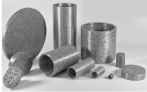
Şekil 2.4. Boşluk tutucu olarak tuz kullanılan açık hücreli köpük metal örnekleri [8].
