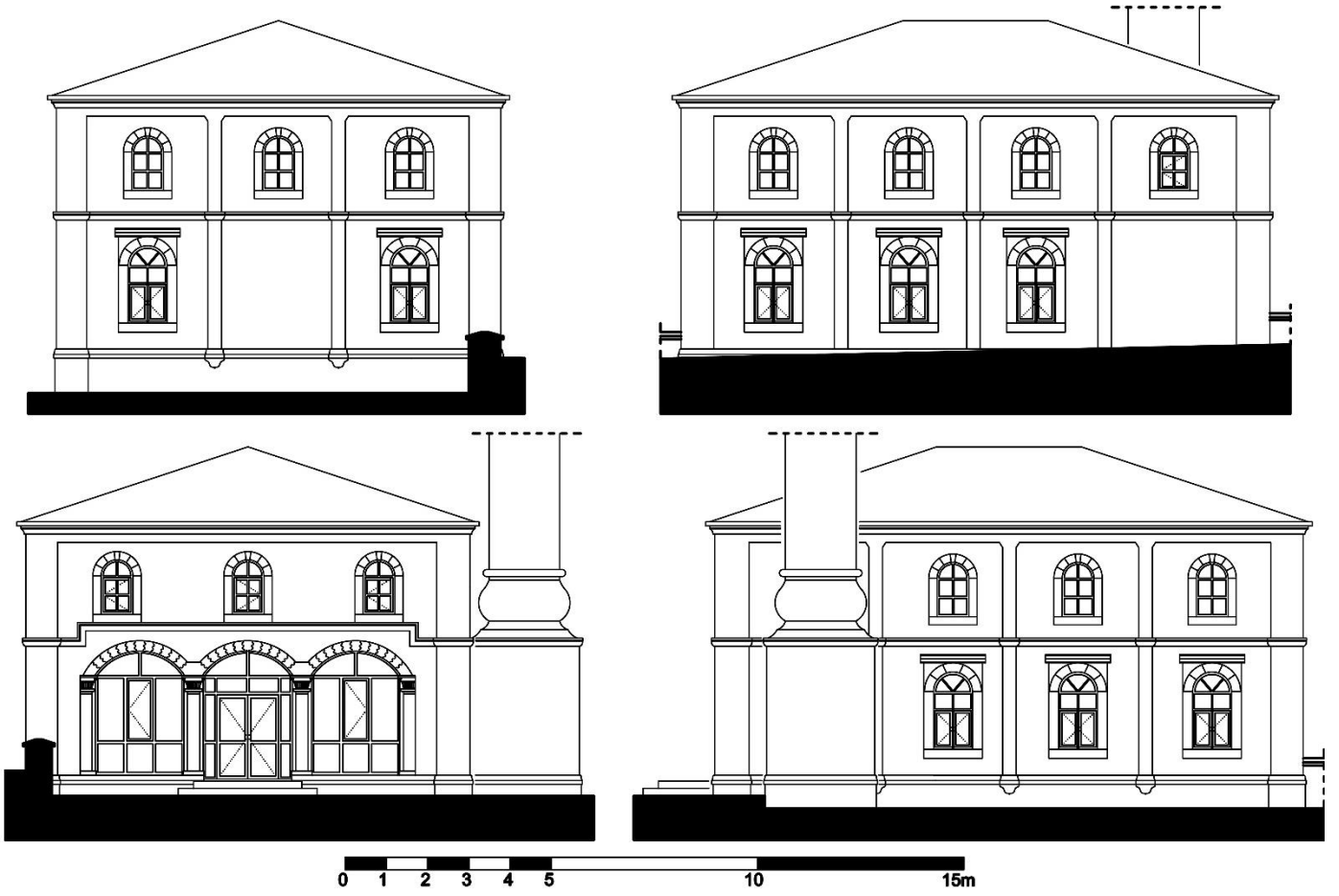
Şekil 13. Nakipzade Camii'nin güney, doğu, kuzey ve batı cephelerinin rölöve çizimleri (Yazar tarafından oluşturulmuştur)
