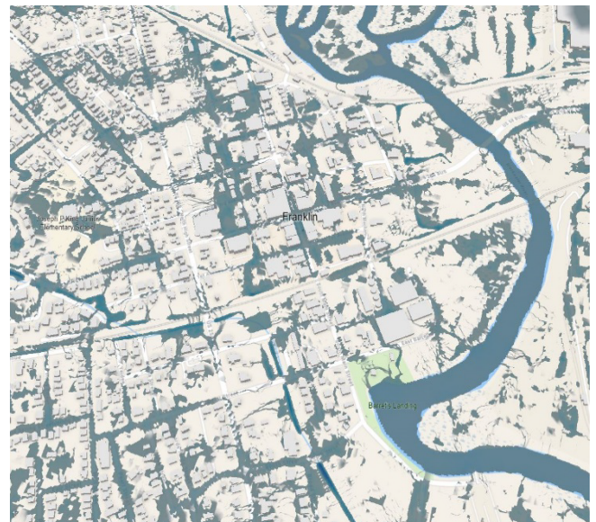
Şekil 7. Taşkın simülasyonu sonucunda oluşan kentsel su baskını.
