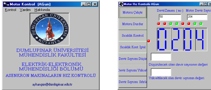
Şekil 7. Tasarlanan DGM inverter için motor hız denetimini sağlayan bilgisayar programı
